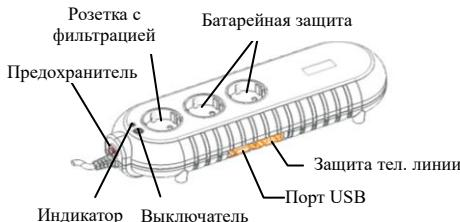
**Выключатель** – включение, выключение, тест ИБП, отключение звука
